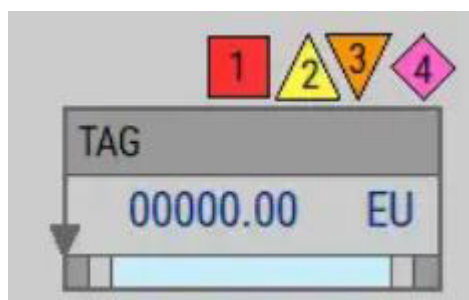
Рис.289. Фейсплейт «Клапана» VLV_05.
