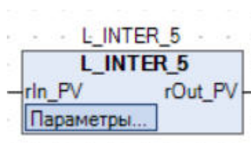
Рис.1. Внешний вид функционального блока L_INTER_05.
