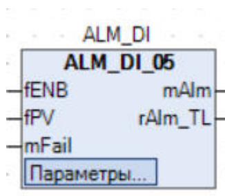
Рис.64. Внешний вид функционального блока ALM_DI_05.
