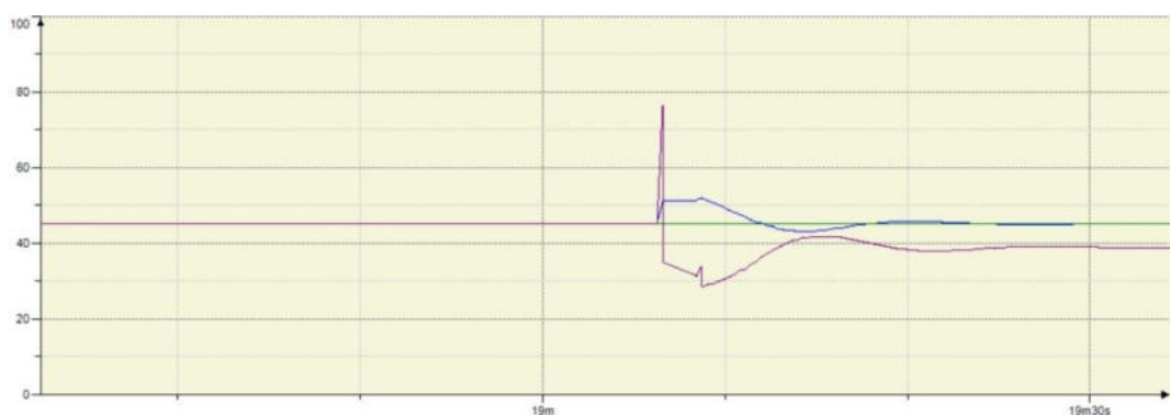
Рис.262. Реакция на внешнее ступенчатое возмущение.
