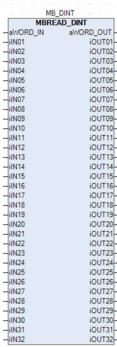
Рис.295. Внешний вид функционального блока MBREAD_DINT.
