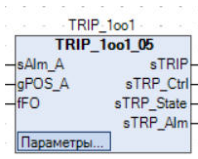
Рис.140. Внешний вид функционального блока TRIP_1oo1_05.
