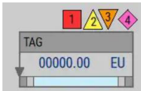
Рис.101. ГЭ «Аварийная сигнализация» AI_05.
