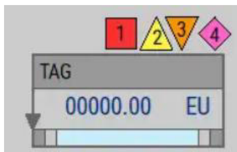
Рис.202. Фейсплейт «Температура насыщения» STR_05.
