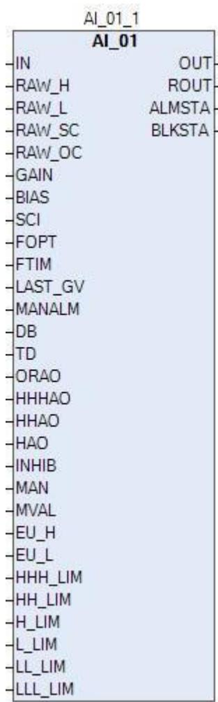
Функциональный блок предназначен для обработки входного аналогового сигнала. Обработка включает в себя:
