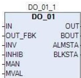
Функциональный блок предназначен для обработки выходного дискретного сигнала.
