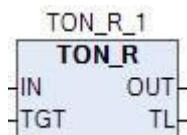
Функциональный блок предназначен для формирования задержки на включение входного сигнала.
