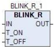
Функциональный блок предназначен для формирования периодического сигнала прямоугольной формы. При изменении входа IN в TRUE, блок формирует сигнал прямоугольной формы длительностью T\_ON и паузой T\_OFF.
