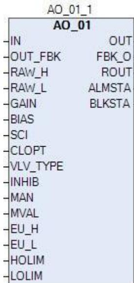
Функциональный блок предназначен для обработки выходного аналогового сигнала.
