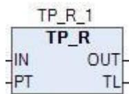
Функциональный блок предназначен для формирования импульса заданной длительности. При изменении входа IN в TRUE, выход OUT принимает значение TRUE на время PT. После истечения времени OUT принимает значение FALSE. Выход TL предназначен для отображения оставшегося времени до активации выхода.
