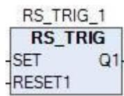
Функциональный блок предназначен для переключения состояния с приоритетом по выключению.
