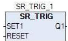
Функциональный блок предназначен для переключения состояния с приоритетом по включению.
