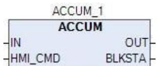
Функциональный блок предназначен для суммирования значение числа с плавающей запятой, подаваемой на вход IN.
