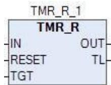
Функциональный блок предназначен для формирования импульса по истечении заданного времени. При изменении входа IN в TRUE начинается отсчет времени TGT, после истечения времени выход OUT принимает значение TRUE. Если время TGT не закончилось и вход IN изменил состояние в FALSE, то отсчет времени останавливается, после изменения входа IN в TRUE таймер продолжает отсчет времени. Вход RESET сбрасывает таймер. Выход TL предназначен для отображения оставшегося времени до активации выхода.
