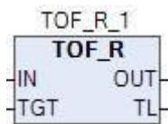
Функциональный блок предназначен для формирования задержки на отключение. При изменении входа IN в TRUE, выход OUT принимает значение TRUE. При изменении входа IN в FALSE начинается отсчет времени TGT, после истечения времени выход OUT принимает значение FALSE. Выход TL предназначен для отображения оставшегося времени до отключения выхода.
